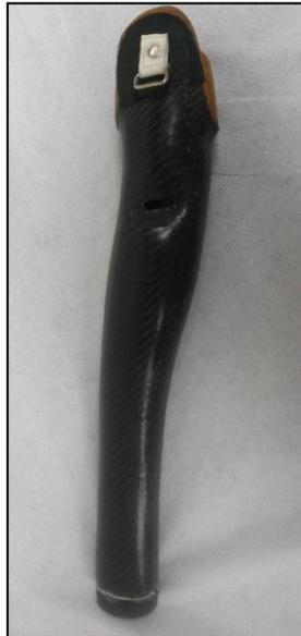
Figura 2: Imagen de la prótesis para extremidad superior para correr que se diseñó en este estudio.
